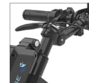
ASISTENTE DE TRAYECTORIA Mayor comodidad y seguridad en la conducción El sistema centrador de dirección endereza el PAWS cuando se suelta
