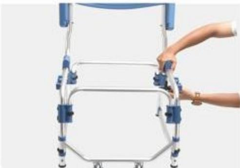
6- Enrosque las 4 palometas por debajo del chasis hasta que quede el respaldo bien sujetado.
