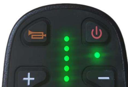
Figura 2 - Indicador de alimentação na unidade de controlo
