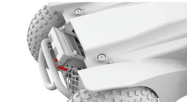
Figura 4.6a Palancas de freno de Extreme X8 activadas
