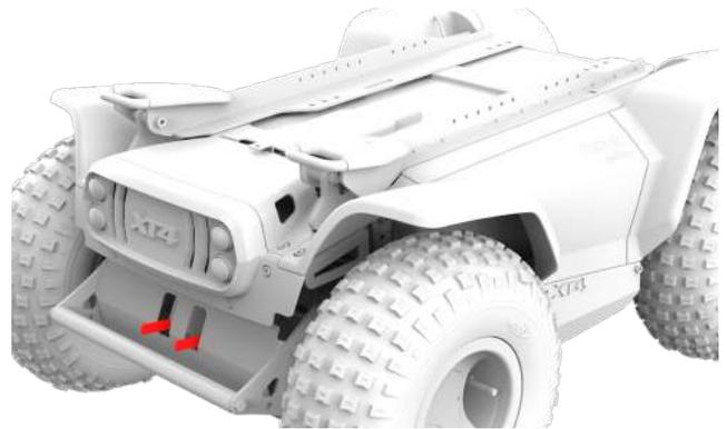
Figura 4.7b Palancas de freno de XT2 y XT4 liberadas
