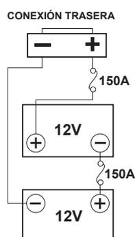
Figura 6.1a - Cableado de la batería de Magic 360
