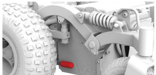
Figura 4.5d Palancas de freno Frontier V4 liberadas
