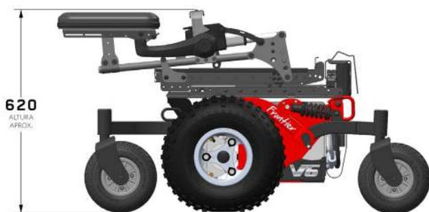
Figura 4.3c Altura plegado Frontier V6 y V4
