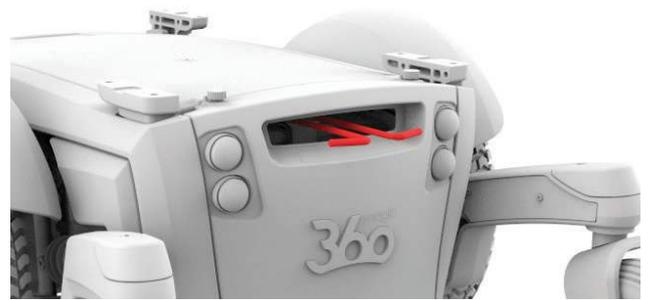
Figura 4.4b Palancas de freno de Magic 360 liberadas
