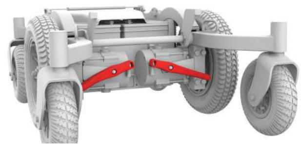
Figura 4.5b Palancas de freno de Frontier V6 liberadas
