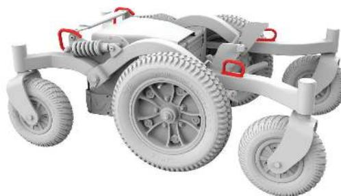
Figura 5.2b Puntos de elevación de Frontier V6
