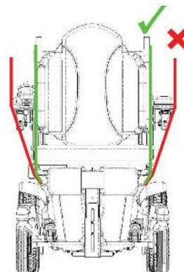
Figura 5.1 Recorrido de las correas de elevación
