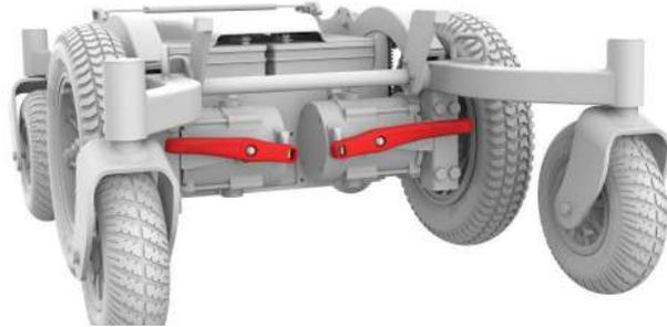
Figura 4.5a Palancas de freno de Frontier V6 activadas
