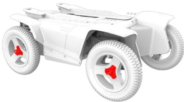
Figura 5.2e XT2 puntos de elevación (vendidos por separado)
