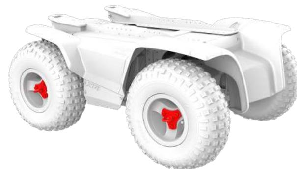
Figura 5.2f XT4 puntos de elevación (vendidos por separado)
