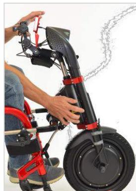
Si el dispositivo está equipado con la palanca **P** para facilitar la operación de liberación, empuje la palanca hacia afuera para presionar el botón **O**; consulte el capítulo 17.6.
