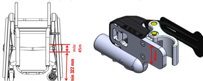
**Anchura delantera de armazón: 220 - 245 mm** (medida de interior a interior del tubo)
