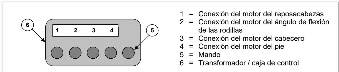
**i** Los conectores de los motores están marcados con el mismo número que las conexiones del transformador.
