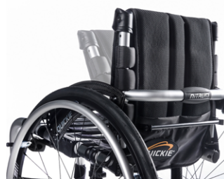
// NTR030157 Respaldo Standard con barra para el plegado
