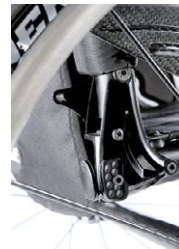
// NTR030015 Respaldo plegable, ajustable en ángulo
