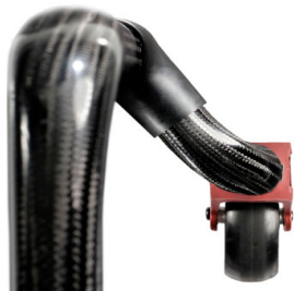
KRF010301 Ángulo standard del tubo de la horquilla, más abierto, y posición de la rueda adelantada
