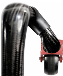
KRF010302 Ángulo más cerrado del tubo de la horquilla, y posición de la rueda retrasada
