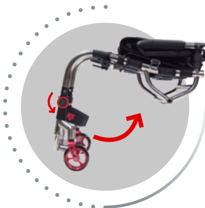
PASO 3 Utiliza el sistema Q-Lock™ para plegar hacia arriba el armazón inferior.
