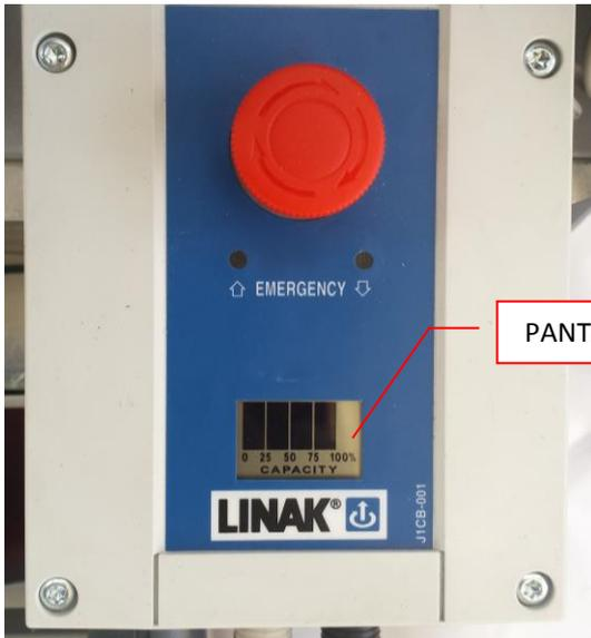
Para comprobar el estado de carga de la batería es suficiente verificar la iluminación de las señales luminosas puestas en la pantalla.
