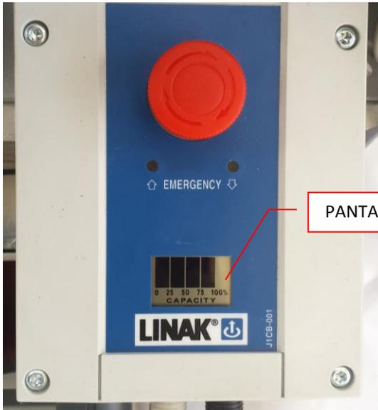
En funcionamiento normal, en la pantalla se muestra la carga restante de la batería.
