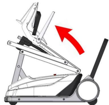
Alinear los orificios de bloqueo (A) de los brazos, estructura y actuador.
