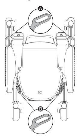
La silla de ruedas está equipada con cuatro puntos de sujeción utilizados para el transporte 🖨 🛪 😠. Dos en la parte delantera 🌢 y dos en la parte trasera 🖲.
