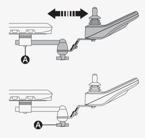
Puede ajustar el ángulo del panel de control giratorio hacia cualquier lado. Así se ajusta el ángulo.
