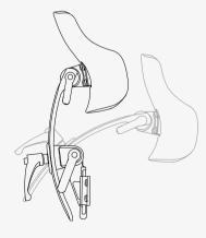
Así se ajusta la altura y la profundidad del reposacabezas.
