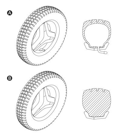
Las ruedas motrices de la silla de ruedas tienen ruedas neumáticas o antipinchazos (rellenas de espuma). Las ruedas giratorias tienen Ruedas neumáticas o ruedas macizas de poliuretano.
