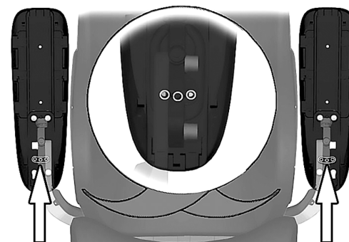
Foto 126. Ajuste de la posición final del pivote de los reposabrazos.
