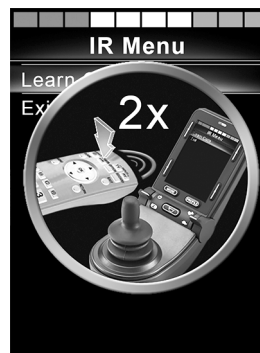
Foto 73. Apunte el control remoto hacia el receptor IR. Pulse el botón dos veces.
