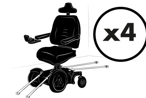
Foto 163. La silla de ruedas tiene cuatro puntos de amarre. La silla de ruedas y la posición amarre de esta imagen son genéricas.
