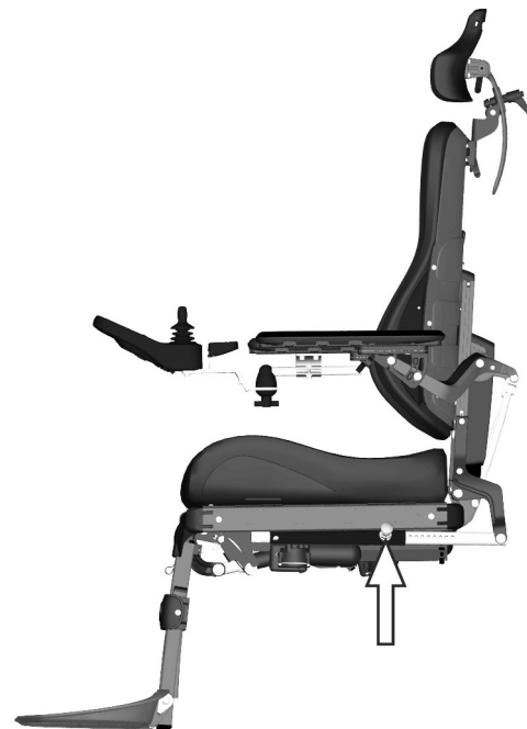
Foto 17. Tubo de abrazadera manual para reclinar el respaldo.
