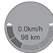
Foto 39. Indicador de velocidad máxima.
