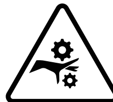
Foto 7. Peligro de aplastamiento.
