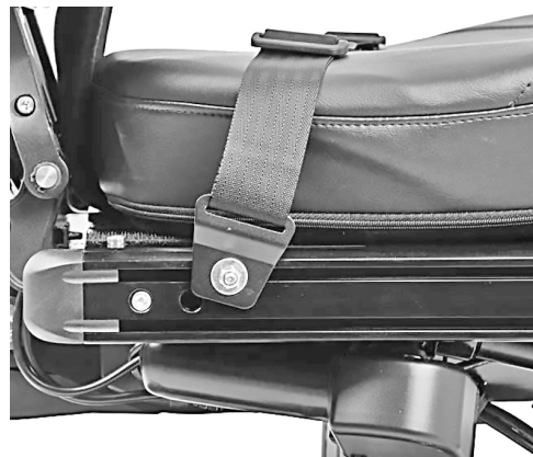
Foto 142. Abroche del cinturón de posicionamiento
