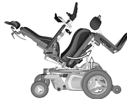
Foto 13. Inclinación del asiento eléctrico
