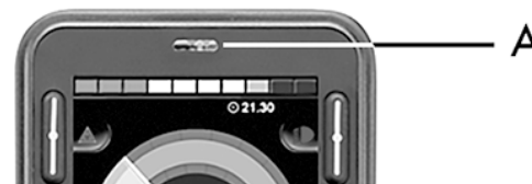
Foto 66. La ubicación del receptor de IR.
