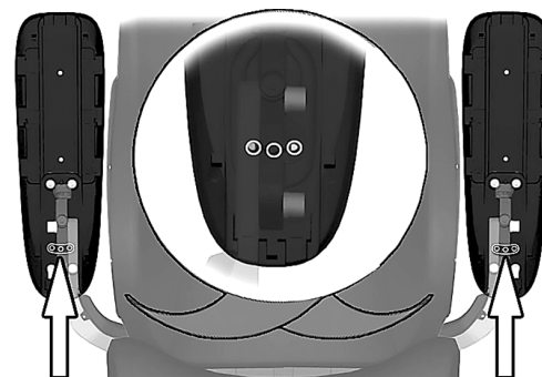
Foto 123. Ajuste de la posición final del pivote de los reposabrazos.
