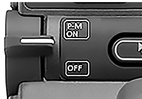
Foto 26. Interruptor de palanca de la alimentación, modo y perfil.
