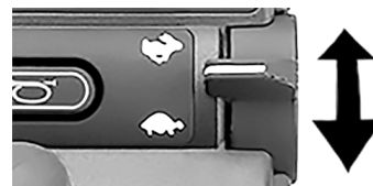
Foto 62. En modo Bluetooth®, el interruptor de palanca derecho se utiliza para desplazarse hacia arriba o hacia abajo.
