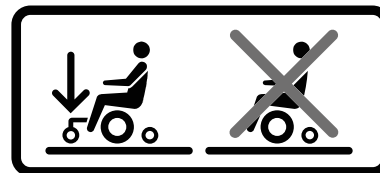
Foto 6. Las ruedas de apoyo siempre deben estar instaladas al conducir.
