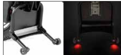
Caballete con suspensión. Incluye doble luz trasera LED.
