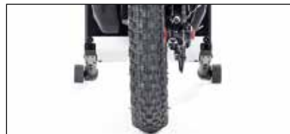
Rueda de 19" con neumático ultra adherente y llanta de aluminio negra de doble pared.
