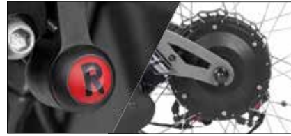
Motor de alta potencia Brushless de 300 RPM 1440 W con marcha atrás. Velocidad máxima 30 km/h.
